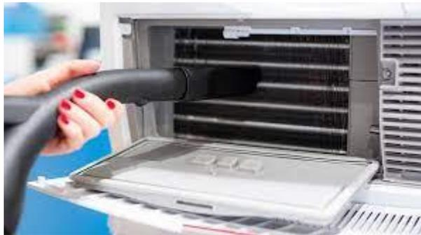
Wärmetauscher regelmäßig kontrollieren und sehr vorsichtig reinigen!
