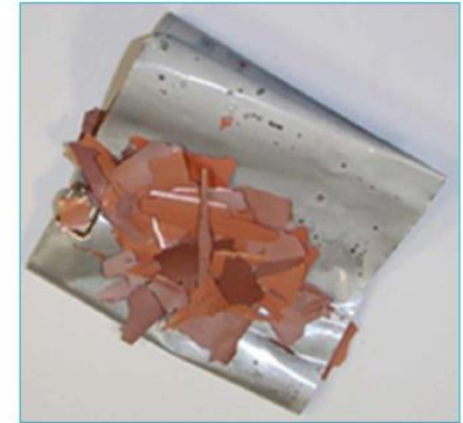
Bild 11: Thermische Behandlung einer Kathode; unbehandelte (links) und behandelte Kathode (rechts)
